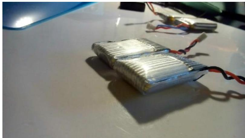
Ce phénomène est normal, mais si l'enveloppe gonfle trop, elle devient plus fragile et peut se rompre, puis au contact de l'humidité contenue dans l'air le lithium s'enflammera.
